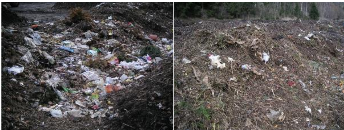
Obrázok 13: Ukážka znečistenia BRKO zo systému spoločného zberu kuchynského a záhradného BRO pomocou nádob bez použitia kompostovateľných vreciek
