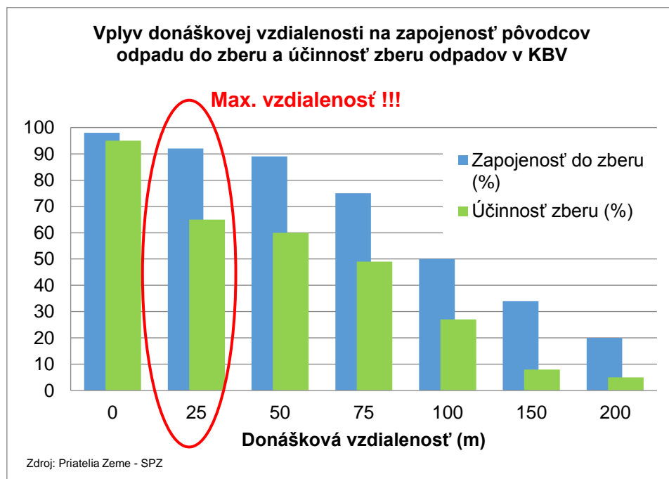
Graf 9: Vplyv donáškovej vzdialenosti na zapojenosť pôvodcov odpadov do zberu a účinnosťou zberu BRKO (z celkového potenciálu) v KBV (Zdroj: Priatelia Zeme – SPZ)
