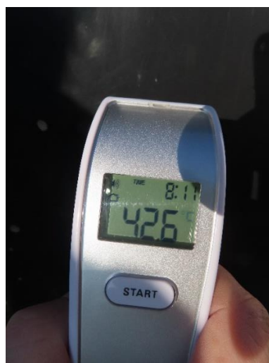
Obrázok 2: Teploty namerané 2. marca 2021 na povrchu nádoby a vo vnútri nádoby. Nádoba bola umiestnená na slnku pri vonkajšej teplote 10 °C
